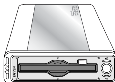
正しい設置方向 製品名ロゴの面を上にする
